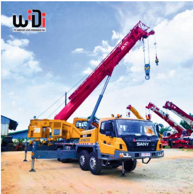
Mobile Crane 55 Ton Sany STC550C5
